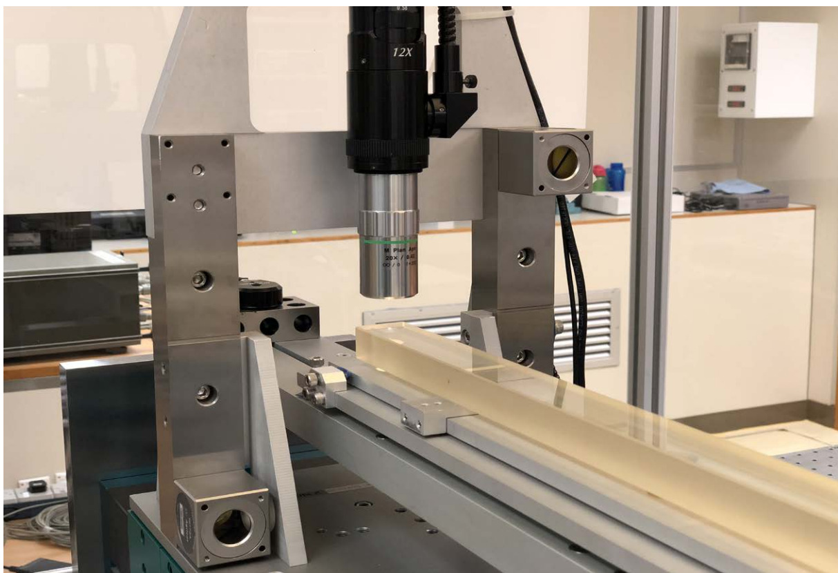
Calibración de una regla de cristal de 500 mm
