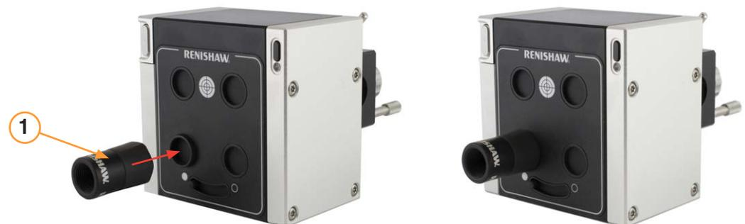
La cubierta del haz se ajusta a presión en la abertura de giro del receptor.
