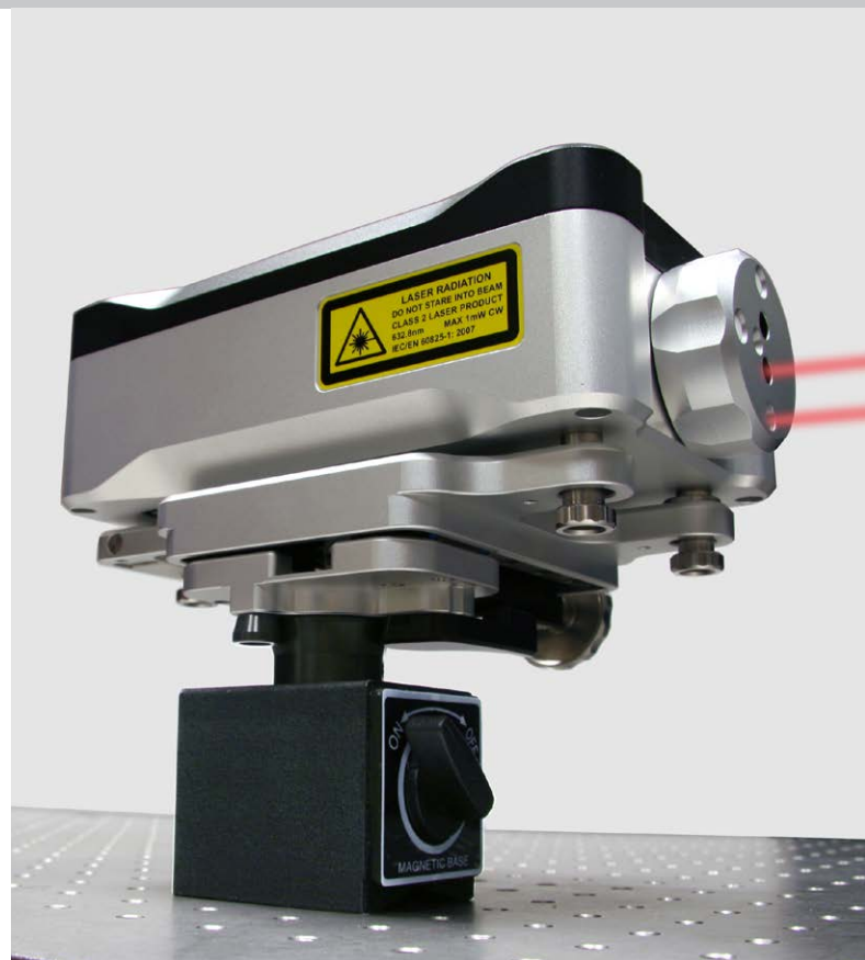
Laserowy system XL-80 zamontowany na podstawie magnetycznej
