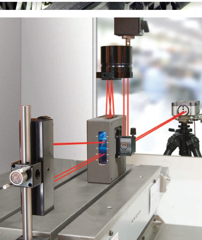
Pomiar prostokątności w osi pionowej
